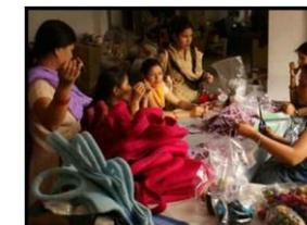
Les pièces de feutrine sont réalisées dans les ateliers en empilant des couches de laine et en les frottant longuement et constamment avec de l'eau et du savon pour emmêler les fibres.
